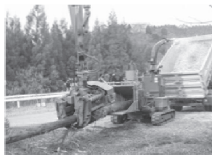
未利用間伐材の燃料用チップ化試験
