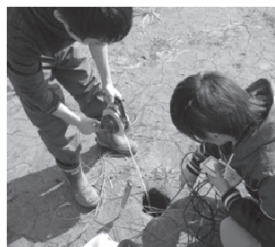
地下水のECと水位計測
